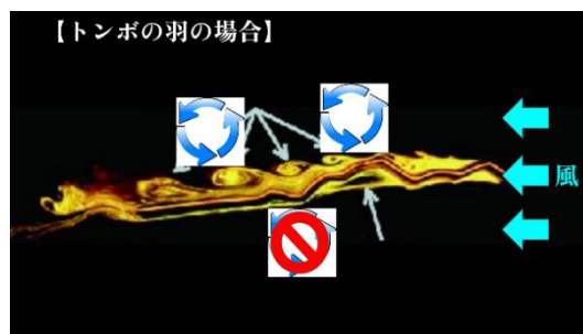
図2 翅の上側だけ空気が速く流れる
